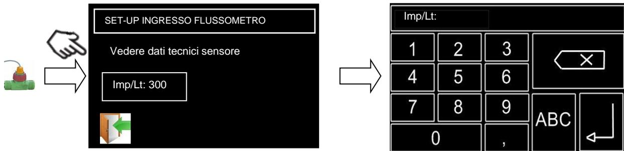
In questo menù è possibile impostare il valore degli impulsi litro del flussometro. Premendo in corrispondenza del parametro si abilita la modifica, comparirà una finestra per l'inserimento dei dati nella quale sarà possibile inserire il nuovo valore del parametro. Confermando con il tasto Enter si abilita la modifica . E' possibile ricavare tale valore dalla targhetta posta sul trasduttore stesso.
