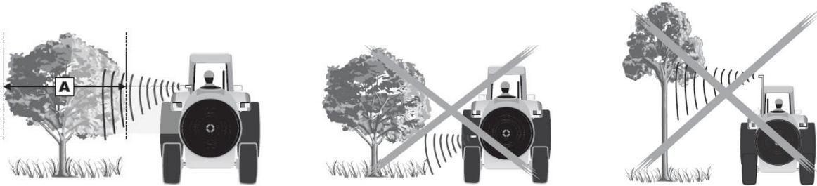
I sensori devono essere fissati sempre in posizione parallela al terreno e perpendicolare rispetto alla pianta.
